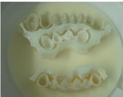
Этот проверенный метод, применяемый опытными специалистами, особенно эффективен для больших мостов. «Удерживающий» эффект дополнительной поддержки диоксида циркония предотвращает коробление больших мостов с плотными ponticными областями, которые сжимаются сравнительно больше, чем абдаменты.
