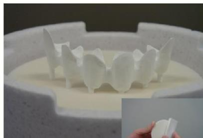
Этот метод уменьшает трение поверхности и позволяет каркасу «скользить» по плоским штырям при его усадке. Обязательно регулярно полируйте поверхность круглой пластины из диоксида циркония, протирая ее шлифовальным камнем. Эта пластина от Katana, Noritake и хорошо работает для предотвращения "деформации" вашей структуры. (для DelCam и других пользователей открытого программного CAM)
