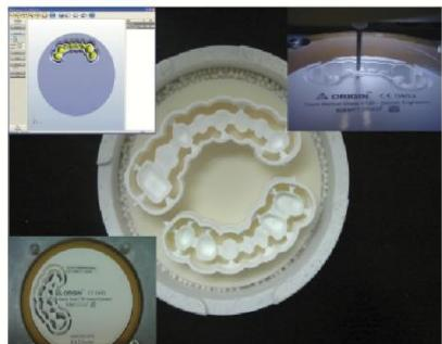
Это еще один проверенный метод для средних и крупных узловых мостов, используемый аутсорсинговыми центрами. Окружающая стена, автоматически спроектированная программным обеспечением CAM, обеспечивает равномерную и равномерную усадку. Он предотвращает деформацию, даже несмотря на то, что есть плотные ponticные области, которые сжимаются значительно больше, чем прижимы к абдаменту (пользователи программного обеспечения ORIGIN CAM)
